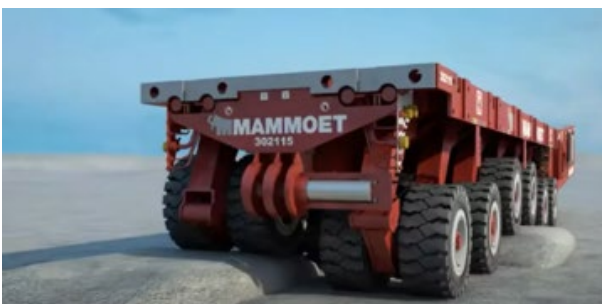
Vagnen kan hålla bärplattan horisontell ( www.samhallsomvandling.lkab.com )
